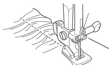
Este prensateles sirve para realizar fruncidos suaves en telas finas. La parte inferior del prensateles esta sobrealzada detrás de la aguja y tiene una barra gruesa frente a la aguja para fruncir y poner un volante en una pieza plana al mismo tiempo. Utilice un ondulator para obtener un fruncido aun más espectacular.
