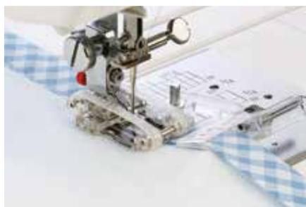
El accesorio para cintas de bias es ajustable y permite colocar cintas de bias dobladas de hasta 20 mm de anchura.
