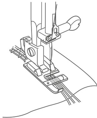
El prensatelas de acordonado triple permite sujetar uno, dos o tres cordones finos o hilos. Los cordones están unidos al prensatelas, lo que permite seguir fácilmente el trazado del diseño y posicionar perfectamente los cordones. Permite coser numerosas puntadas útiles y decorativas para adornar los cordones de una tela básica. El cordón, el hilo y la puntada elegidos contribuyen todos al efecto final.
