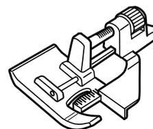
La guía de este prensateclas alinea los bordes de la tela con las costuras para realizar fácilmente costuras de borde paralelas y puntadas de sobrehiado. Ajuste la guía con la ayuda del tornillo para que la costura y el borde coincidan exactamente.
