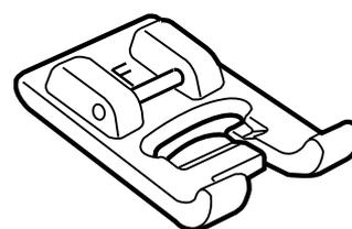
Para coser puntadas de zig zag tupidas. La parte inferior del prensateles esta biselada para permitir una alimentación suave del hilo a la hora de realizar puntadas decorativas o satinadas. Fabricado con plástico transparente para una mejor visibilidad mientras cose.
