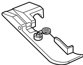
Con la función de dobladillo enrollado de su máquina, puede aprovechar al máximo el prensatelas de cordón A. Este prensatelas es ideal para los trajes de novia y las prendas de noche, y le permite insertar un hilo fino de pesca mientras enrolla el borde del material para obtener un bonito acabado firme y flexible.
