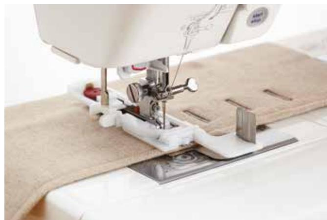
Instalando el prensatelas para ojales R con la placa estabilizadora para ojales, la máquina arrastra diferentes tipos de tejidos y capas irregulares de manera más suave en lugar de comerse el tejido o de bloquear la aguja.
