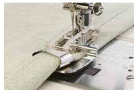
Los accesorios para dobladillo enrollado ancho permiten coser los dobladillos enrollados con las medidas siguientes: 1/2 pulgada, 3/4 pulgada, y 1 pulgada.
