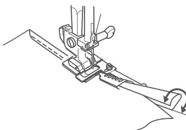
El prensateles para bias sirve para insertar en el borde de la tela cintas de bias pre-dobladas o cintas de bias previamente cortadas en un solo paso. Está equipado con un pequeño embudo para plegar y guiar la cinta a lo largo del borde de la tela antes de llegar a la aguja, y se puede usar tanto para puntadas de zig zag, como para puntadas decorativas o rectas. Compatible con cintas de bias de 10 mm a 14 mm.
