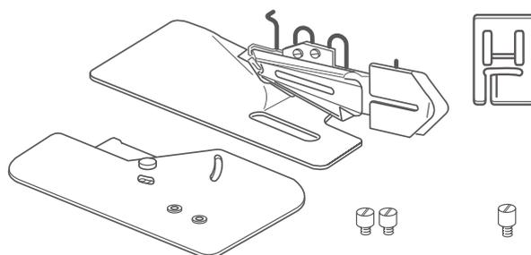
Use el juego para bies de acolchado para realizar bies de 1/2" logrados en una tela acolchada o en otras telas gruesas. Ajuste los dos tornillos superiores para alinear las partes superiores e inferiores del bies con la aguja y conseguir una mayor precisión. El juego permite realizar bies de línea recta para acolchados largos, y añade atractivo a todos los artículos pequeños como los manteles individuales y las almohadillas.
