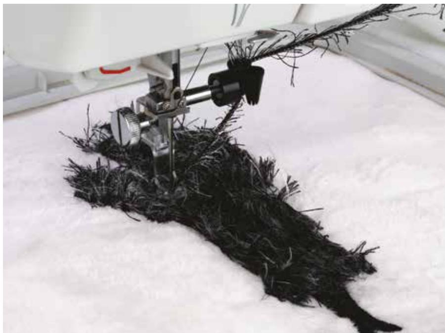
El cepillado de bordado utiliza los hilos que se pueden ahuecar después de haber cosido para crear un delicado acabado tridimensional. El kit de cepillado de bordado incluye un prensatelas y un cepillo especiales, y está diseñado para usarlo con el CD-ROM de cepillado de diseños de bordado de Stitchitize.
