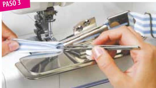
Saque el extremo de la cinta con la punta de las pinzas para insertarla entre las guías superior e inferior del embudo, y pase la cinta por debajo del prensatelas.
